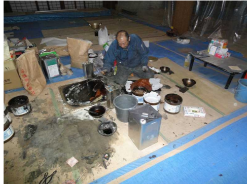
漆を丁寧にこねる、もしくは混ぜています。何度も繰り返して、滑らかな漆を作っています。
